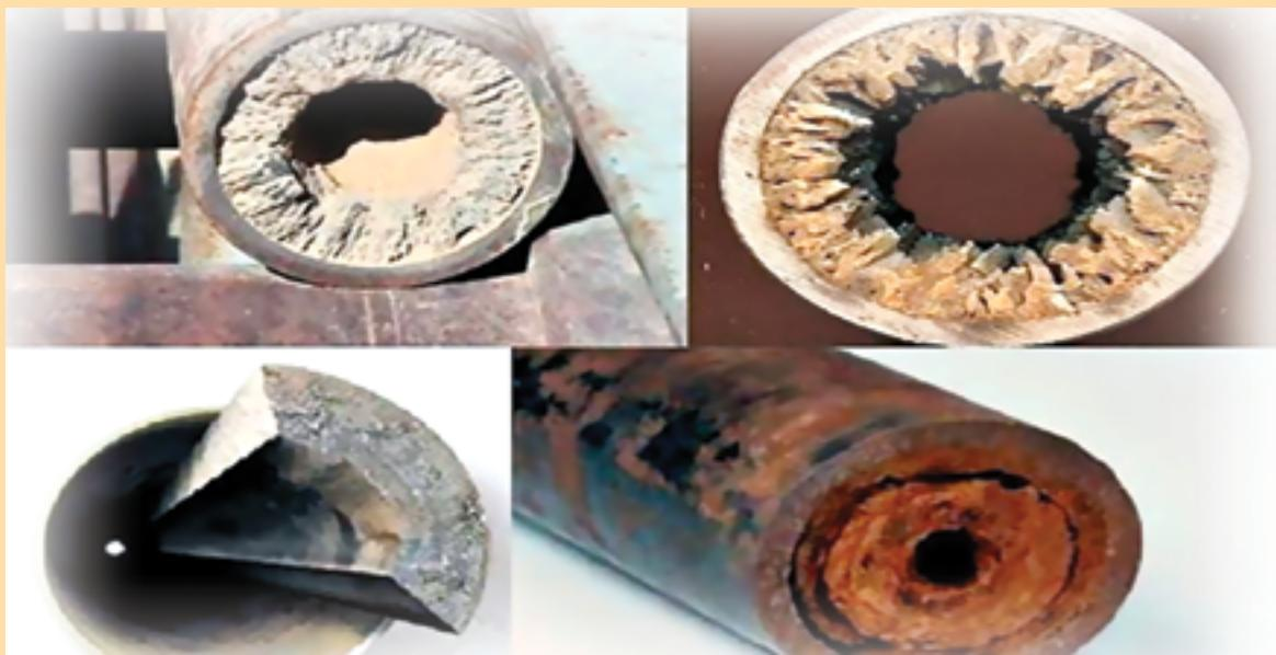
(ناهمگن) چه از لحاظ ماهیت و چه از لحاظ غلظت قرار می‌گیرد و منجر به خوردگی موضعی می‌شود. در این فرایند هرچه احیاء اکسیژن بر روی سطح فلز مجاور رسوبات (محصولات خوردگی) بیشتر باشد، خوردگی موضعی شدیدتری در زیر رسوبات رخ می‌دهد. در سطح خارجی رسوب، اکسیژن حل شده به دو طریق هدایت و نفوذ به سطح می‌رسد در حالی که مطابق با تصویر شکل (۵) محلول داخل رسوبات متخلخل صرفاً به طریقه نفوذ اکسیژن خود را فراهم می‌کنند.
